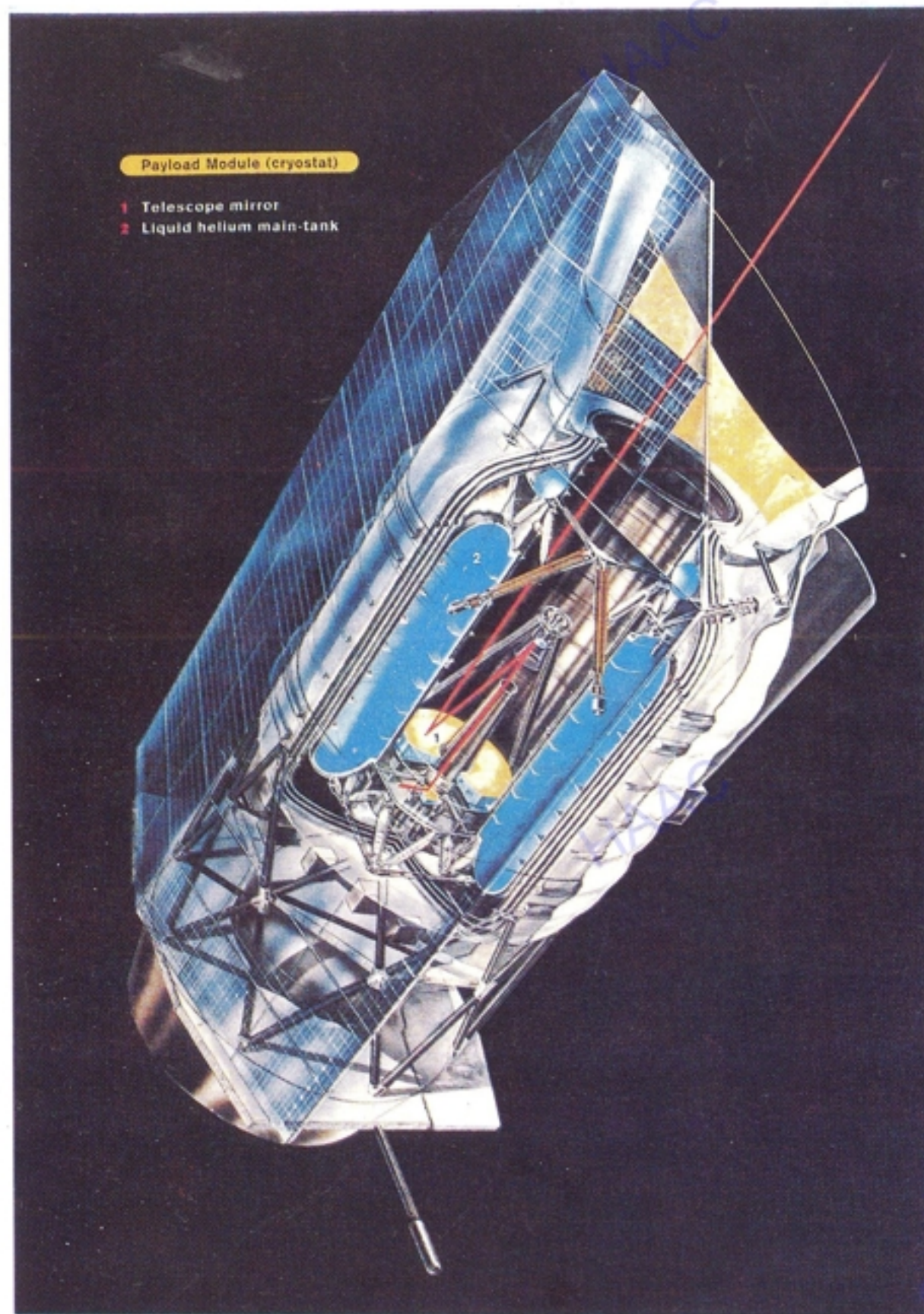
Hình 12 : Trạm quan sát ISO (Infrared Space Observatory - Đài thiên văn hồng ngoại) mang kính thiên văn có đường kính 60 cm (trong hình là kính thiên văn (1) thiết bị đo đặc được ướp trong một bình đầy Heli để giữ nhiệt độ không quá -217^{\circ}\text{C}^{(2)} .
